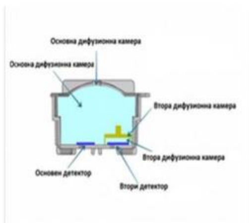
Фигура 1. а) Напречно сечение на RSFV камера б) Снимка на отворен основна камера на RSFV детектор
