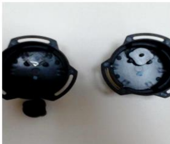
Фигура 1. а) Напречно сечение на RSFV камера б) Снимка на отворен основна камера на RSFV детектор
